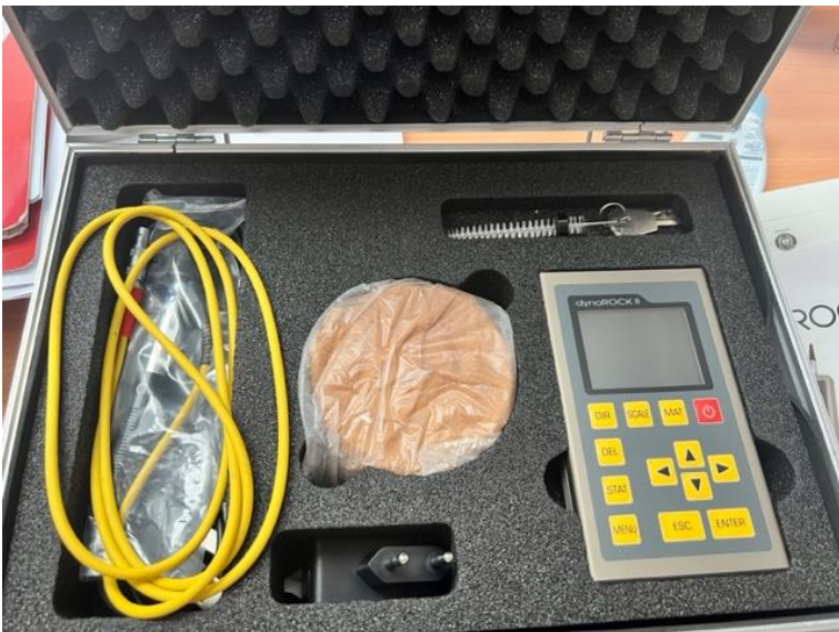
DynaROCK II – prijenosni mjerac tvrdoće (metoda odskoka s udarnim tijelom D) – mjerne skale HRC, HB, HV, HRB, HD, HS, N/mm 2
