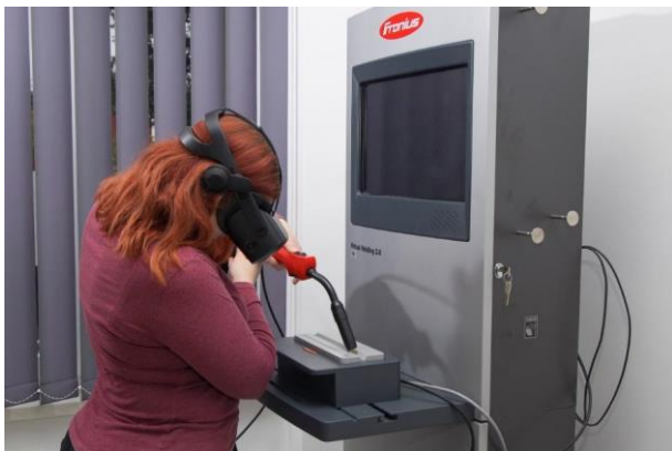
Simulator za zavarivanje REL, TIG i MIG/MAG postupcima FRONIUS Virtual Welding 2.0
