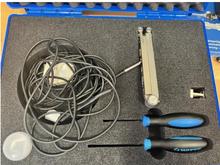
kontaktni elektrotopni ekstenzometar MF – Mess- & Feinwerktechnik GMBH za provođenje ispitivanja prema ISO 6892 za rad u rasponu temperatura 10 do 50°C, za mjerenje pomaka/deformacija na površini epruvete u rasponu 0-20 mm
