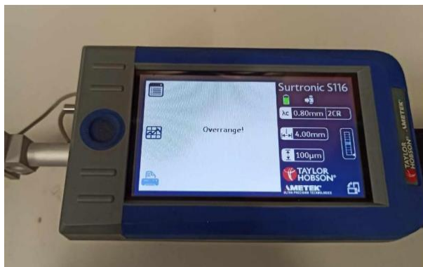
Ručni mjerač hrapavosti AMETEK Taylor Hobson Surtronic S – 116
