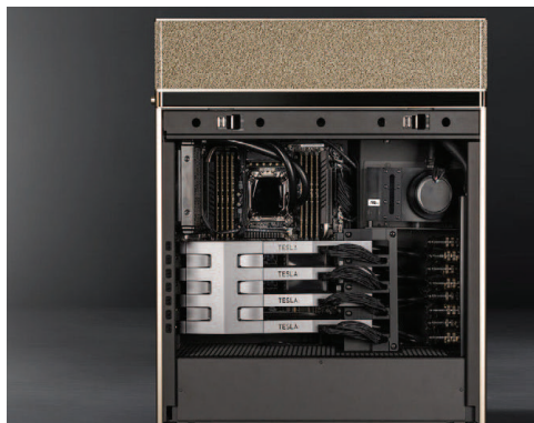
SLIKA 4-2: Unutrašnjost računala DGX-2, sa 16 procesora TESLA T4, prikazanog na istoj konferenciji.
