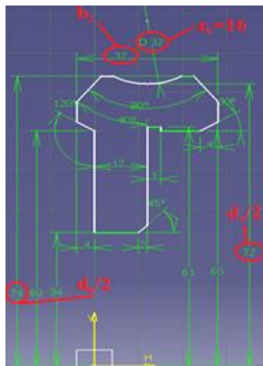
Slika 16. Polazni oblik profila pužnog kotača
