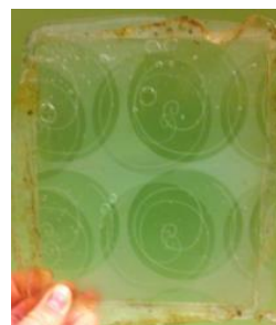
Slika 1. Polimerna ploča izrađena izravnim prešanjem taljevine u peći
