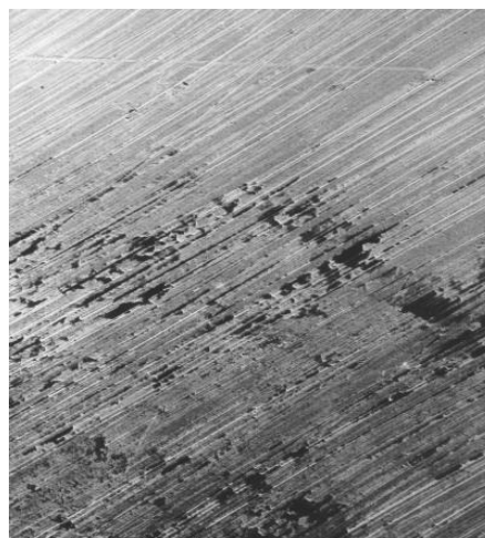
Slika 10. Mikrozarivanje aluminija na strani klipnog prstena – povećanje 100x [2]
