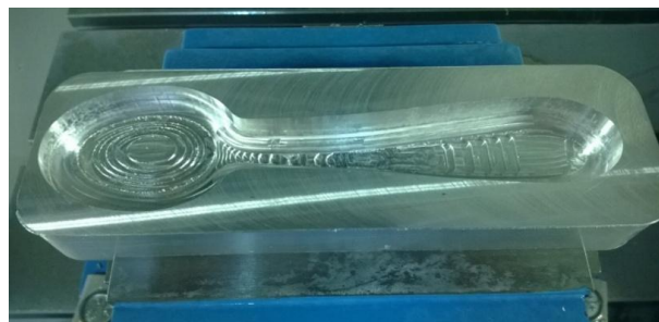
Slika 18. Prikaz gotove operacije 3D glodanja konture matrice
