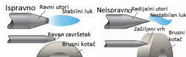
Slika 13. Pravilno i nepravilno brušenje volframove elektrode
