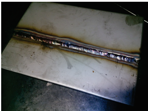
Slika 5. Prikaz zavarenog vodoravnog preklopnog spoja
