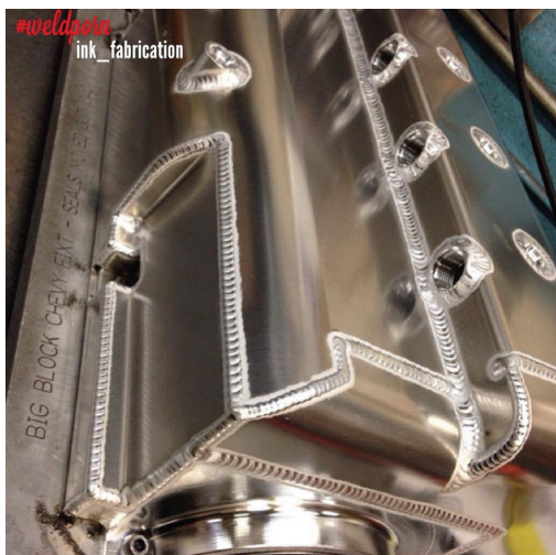
Slika 19. Prikaz sloja razbijenog oksida uz zavar [11]
