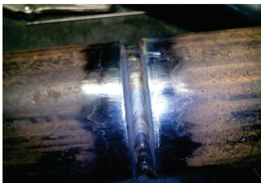
Slika 14. Čelična cijev zavarena TIG postupkom
