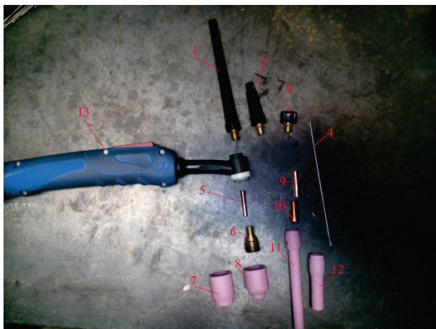
Slika 12. Dijelovi TIG gorionika
