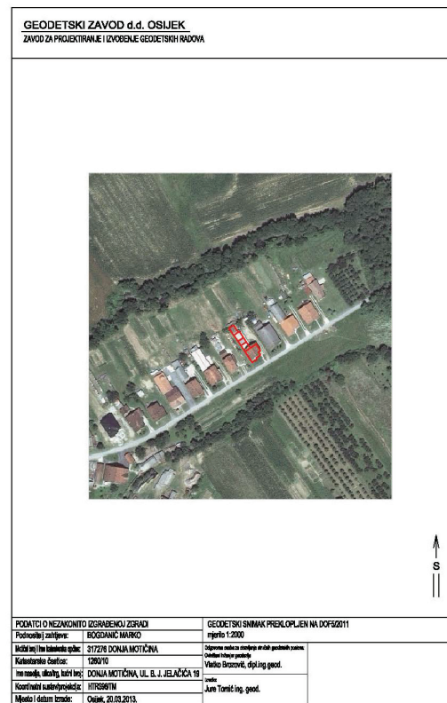
Slika 5. Geodetski snimak preklapljen na DOF5/2011
