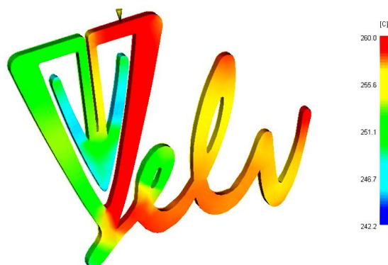
Slika 6. Temperatura čela taljevine za položaj ušća I
