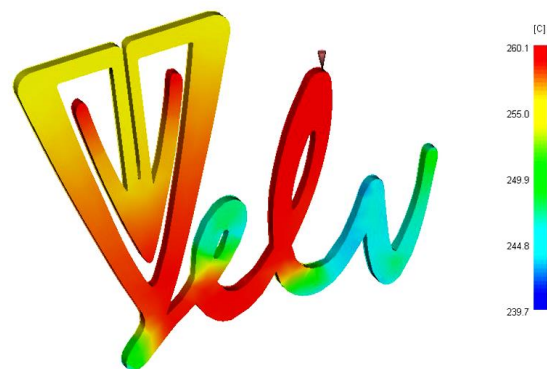
Slika 7. Temperatura čela taljevine za položaj ušća II
