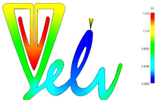
Slika 10. Vrijeme ubrizgavanja – parametri simulacije II
