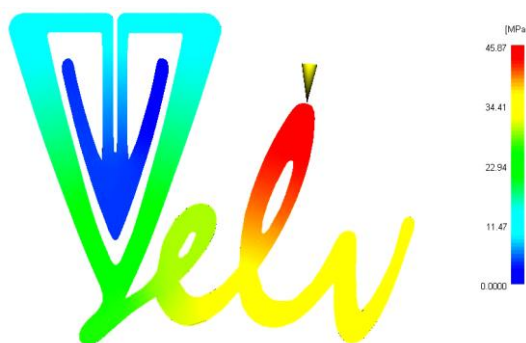
Slika 11. Tlak u kalupnoj šupljini – parametri simulacije II
