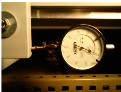
Slika 10. Prikaz testiranja pomoću mjernog sata - početna pozicija
