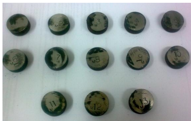
Slika 3. Uzorci nakon obavljene toplinske obrade
