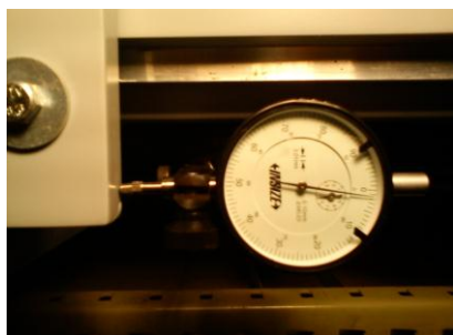
Slika 11. Prikaz testiranja pomoću mjernog sata - završna pozicija
