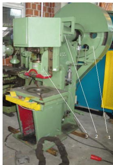
Slika 1. Ekscentar preša starije proizvodnje [1]
