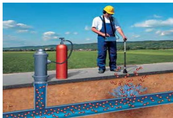
Slika 3. Detektor i traženje šumova od istjecanja iz puknute cijevi
