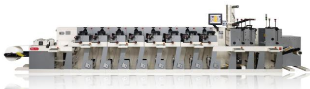
Slika 8. Fleksografski stroj za tisak
