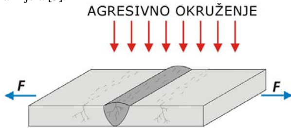
Slika 3. Čimbenici koji utječu na pojavu napetosne korozije [6]
