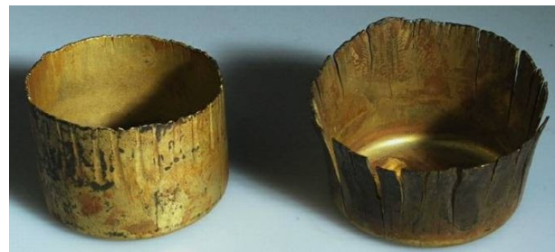
Slika 13. Napetosna korozija čahura streljiva nastala u agresivnom okruženju amonijaka [12]
