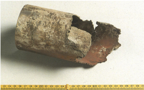
Slika 17. Kloridna napetosna korozija AISI 316 čelika – transkristalan lom [5]
