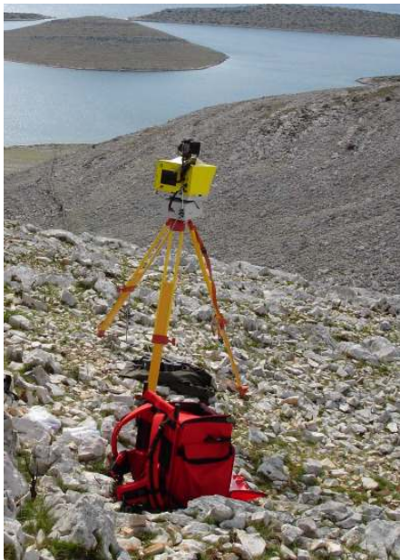
Slika 1. Optech ILRIS postavljen na lokaciji
