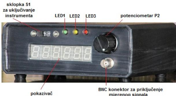
Slika 15. Izgled prednje ploče izrađenog digitalnog frekvencometra
