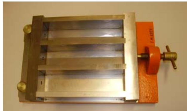
Slika 7. Trodijelni kalup dimenzija 4x4x16 cm za izradu uzorka glazure za ispitivanje tlačne i savojne čvrstoće
