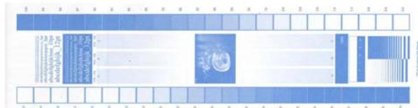
Slika 3. Dio otiska testne forme s prikazanim elementima za mjernu evaluaciju
