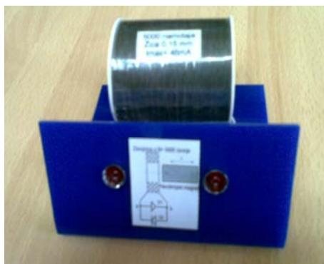
Slika 12. Naprava za određivanje polariteta induciranih napona
