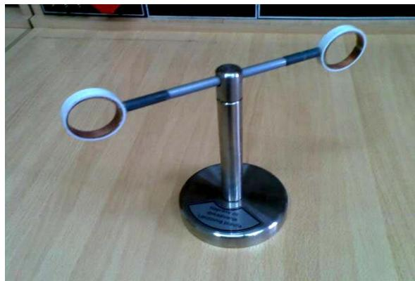
Slika 15. Izvedba naprave s kugličnim ležajem
