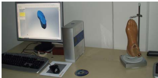
Slika 10. Skeniranje modela noge Skenerom NextEngine
