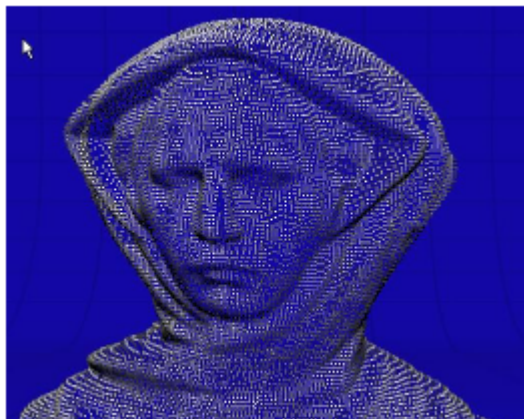
Slika 2. Oblak točaka koji prikazuje skenirani objekt
