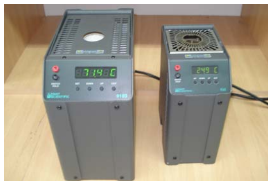
Slika 11: Primjer temperaturnih kupki
