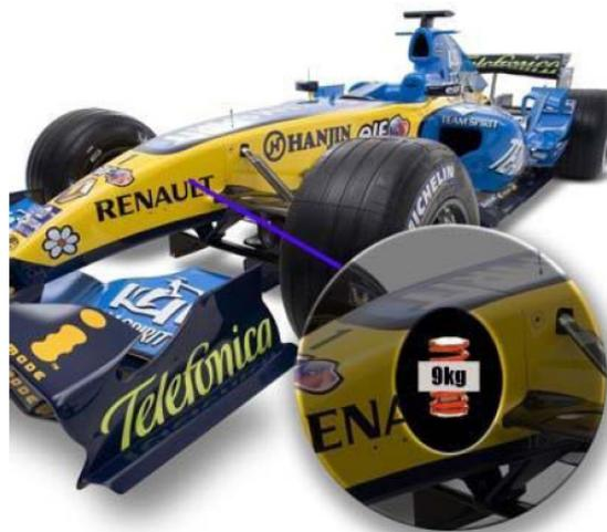
Slika 2. Pasivni dinamički prigušivač na Renault-ovom bolidu [3]
