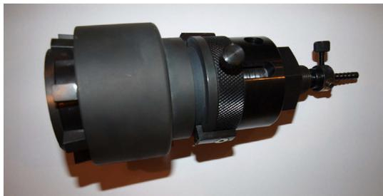
Slika 10. Alat za izradu detonatora
