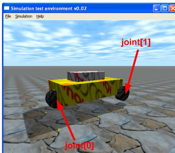
Slika 4. Prikaz zglobova na virtualnom modelu elektromobila (1)
