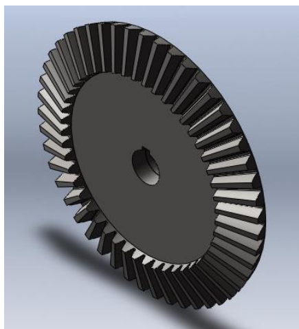
Slika 14. 3D model gonjenoga stožnika z_2 = 48 zubi
