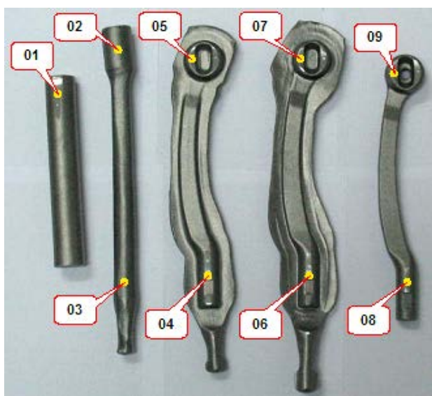
Slika 4. Mjesta mjerenja tvrdoće izradaka
