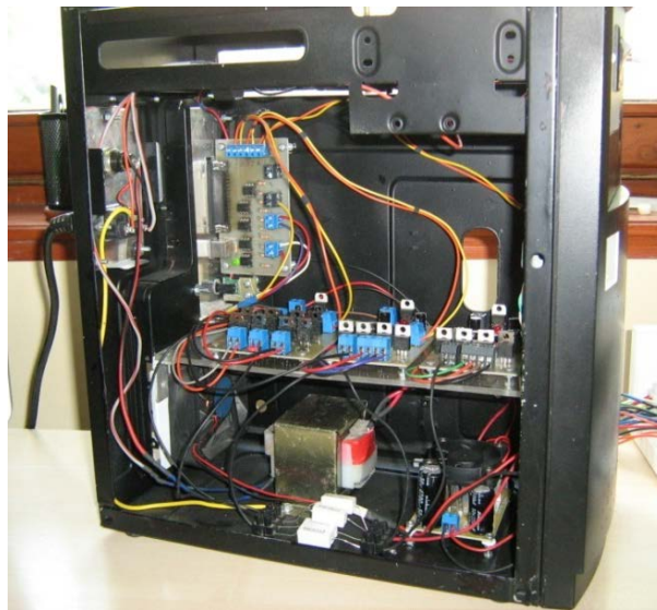
Slika 6. Kućište u kojem su smješteni elektronički sklopovi koji upravljaju CNC strojem
