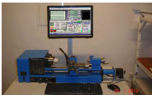
Slika 1. Rekonstrukcija tokarilice Hobbymat MD65 instalirane u laboratoriju za elektrostrojarstvo [1]
